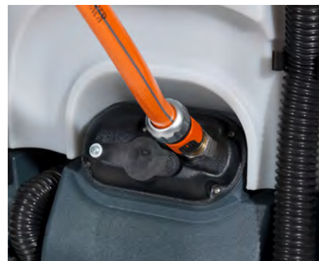
Vattenpåfyllningssystem med snabbkoppling och automatisk avbrytare när tanken är full (tillbehör).
