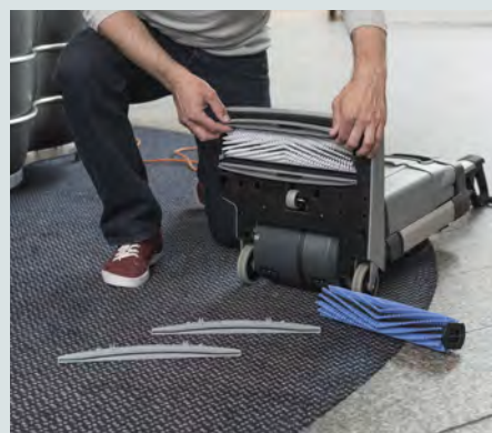
Förutom snabb rengöring av hårda golv kan maskinen också rengöra mindre mattor och ta bort fläckar med hjälp av tillbehörs-setet för mattrengöring. Borste och sugfot kan monteras av utan verktyg, så dagligt underhåll blir snabbt och lätt.
