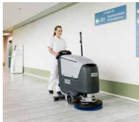
Perfekt för rengöring under dagtid: extremt låg ljudnivå på bara 60 dB(A), tack vare den tystgående sugmotorn och det ljudlösa läget.
